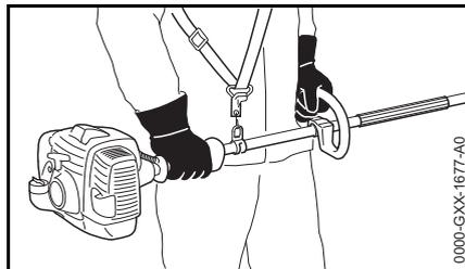
Prendre la poignée de commande dans la main droite et la poignée du tube dans la main gauche – ceci est également valable pour les gauchers. Entourer fermement les poignées avec les pouces.
