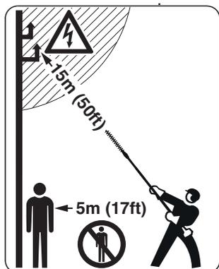
À part l'utilisateur, personne ne doit se trouver dans un rayon de 5 m de la machine en marche – les couteaux en mouvement et la chute des végétaux coupés risquent de causer des **blessures** ! Respecter également cette distance par ex. par rapport à des véhicules garés, vitres etc. – **pour éviter de causer des dégâts matériels** !
