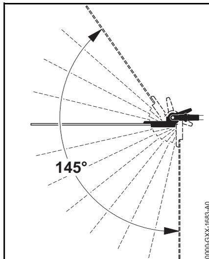
En partant de 0° (barre de coupe droite), la barre de coupe peut être réglée dans 4 positions vers le haut (jusqu'à 55°) et dans 7 positions vers le bas (jusqu'à 90°, c'est-à-dire à angle droit vers le bas). On obtient ainsi 12 positions de travail réglables individuellement.
