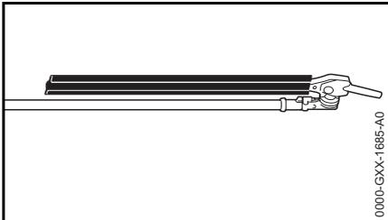
Pour réduire l'encombrement lors du transport, la barre de coupe peut être rabattue et immobilisée dans une position parallèle au tube.
