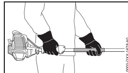
Prendre la poignée de commande dans la main droite et la gaine du tube dans la main gauche – ceci est également valable pour les gauchers. Entourer fermement les poignées avec les pouces.
